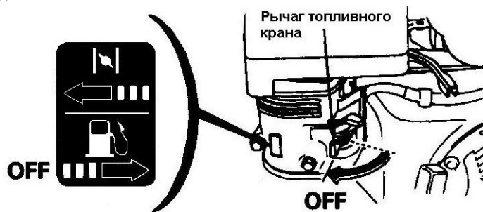
Рисунок 12 – Рычаг топливного крана в положении "OFF" ("Выключено")
