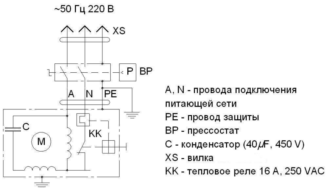
Рисунок А.2 - Схема электрическая принципиальная компрессоров СБ4/С-20.Ј2047В, СБ4/С-50.Ј2047В, СБ4/С-100.Ј2047В, СБ4/С-100.Ј2047ВВ
